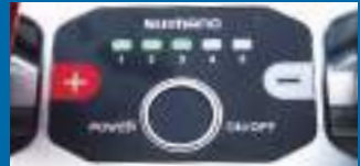
▲水深300～600メートル前後で8回投入を行い、バッテリー容量の約半分が残っていた
