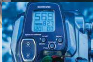
▲ディスプレイには水深、巻き上げ速度のほか、探見曳船搭載であれば水深と海底の変化、アキュファイッシュ対応の観測搭載船では魚群水深が表示される
